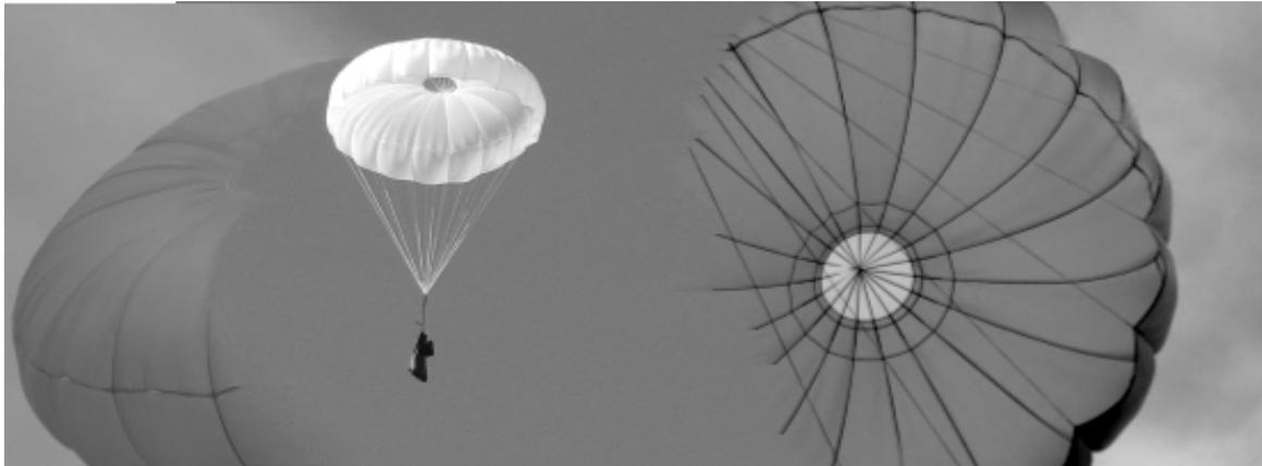
**Snip L** è un paracadute di soccorso a doppia calotta, disegnato e realizzato in modo preciso con profili accurati, una caratteristica evidente osservando la forma pulita della calotta aperta. È dotato di una moderata velocità di avanzamento orizzontale, che contribuisce anche a garantire una migliore stabilità e la possibilità di dirigere parzialmente la discesa. Offre una gran rapidità di apertura grazie al suo peso contenuto, al disegno con doppia calotta e ai cordini di sospensione corti.
